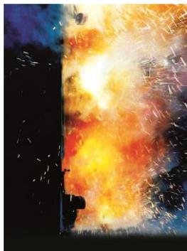
Un **arco eléctrico** es un cortocircuito que ocurre en el aire. Puede ser causado por una falla de equipo eléctrico, polvo conductivo entrando en los gabinetes eléctricos, entrar en contacto por descuido con conductores o circuitos, o dejar caer un objeto conductivo como una herramienta.
